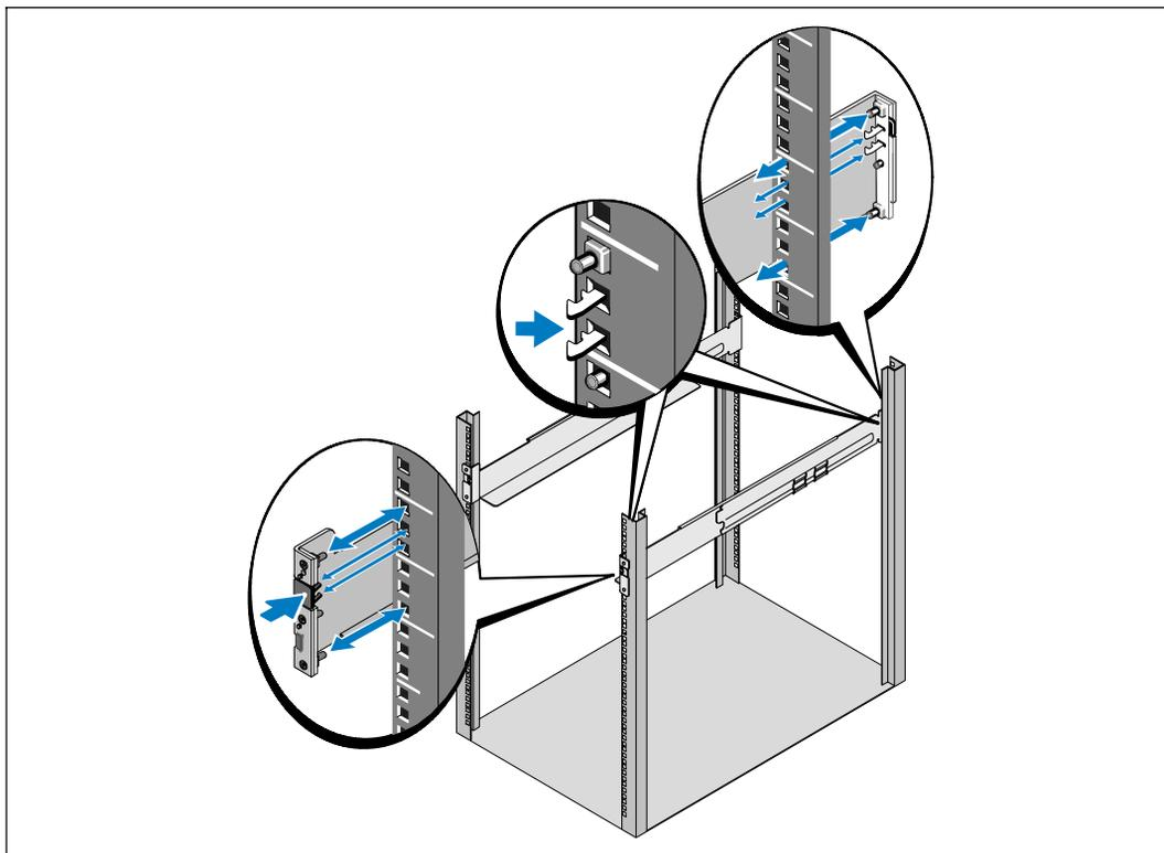
图 9. 安装导轨
