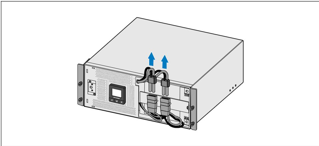
图 25. 断开 UPS 内置电池连接器
