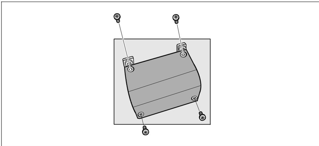
图 18. 取下接线端块外盖
