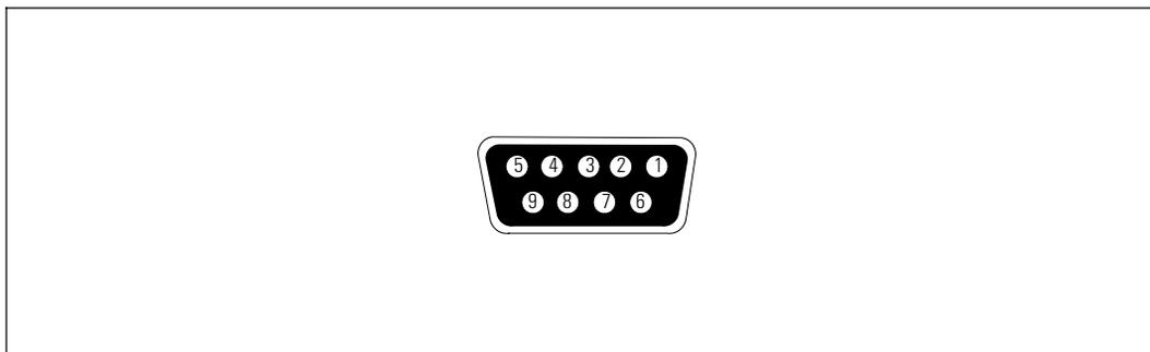
图 22. RS-232 通讯端口（DB-9 连接器）
